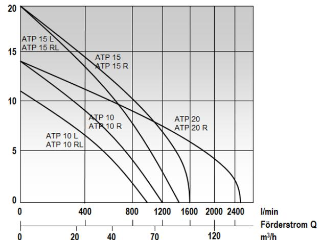
Q l/min, bei H m (Wassersäule), gültig für  $\rho = 1 \text{ kg/dm}^3$  und kinematische Viskosität  $\eta = 1 \text{ mm}^2/\text{s}$ .
