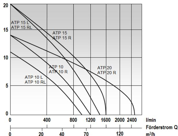
Q l/min. bei H m (Wassersäule), gültig für  $\rho = 1 \text{ kg/dm}^3$  und kinematische Viskosität  $\eta = 1 \text{ mm}^2/\text{s}$ . Förderwert- und Wirkungsgradgarantie nach DIN 1944. Genauigkeitsstufe III.
