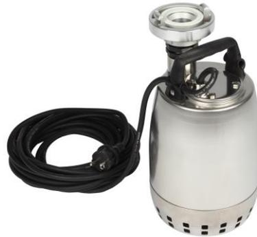
Die Pumpen X 300 / X 300S sind Tauchmotorpumpen für Klar- und fäkalienfreies Schmutzwasser mit 10 mm Korndurchgang. Die robusten Tauchpumpen können als transportable Schmutzwasserpumpen verwendet werden. Sie können ebenfalls als Sumpfpumpen in Hebeanlagenschächten montiert oder als eigenständige Schmutzwasserpumpen in Pumpenschächten oder in Regenwasserbecken installiert werden.
